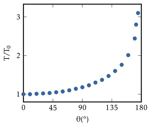
Période  $T$  des oscillations du pendule pour tous les angles. Elle reste proche de  $T_0 = 2\pi\sqrt{l/g}$  jusqu'à environ  $45^\circ$  puis croît de plus en plus rapidement jusqu'à diverger pour  $\theta \rightarrow 180^\circ$ .
